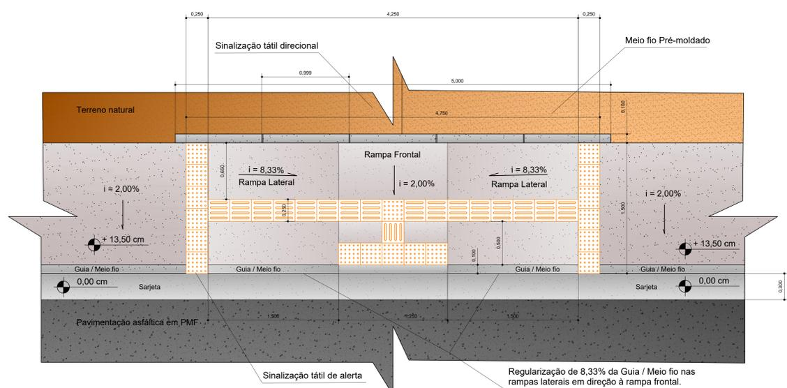
DETALHE EM VISTA SUPERIOR DO REBAIXAMENTO PARA ACESSIBILIDADE DO PASSEIO (CALÇADA)
