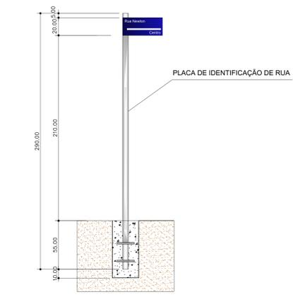
DETALHE PLACA DE IDENTIFICAÇÃO DE RUA SEM ESCALA
