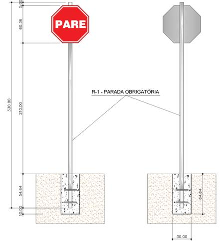
DETALHE PLACA DE REGULAMENTAÇÃO R-1 SEM ESCALA
